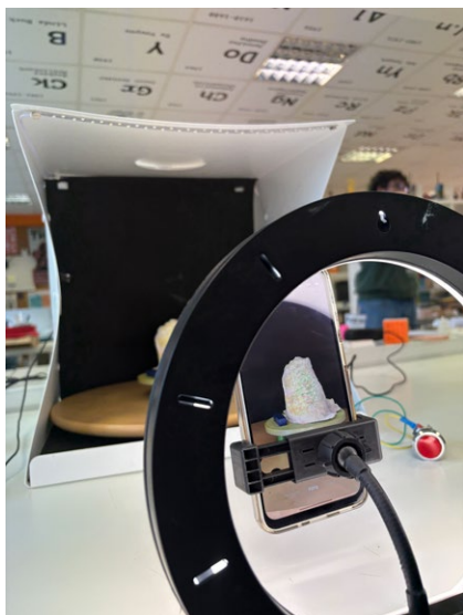
En el proceso de creación del molde se utilizan técnicas de fotogrametría.
