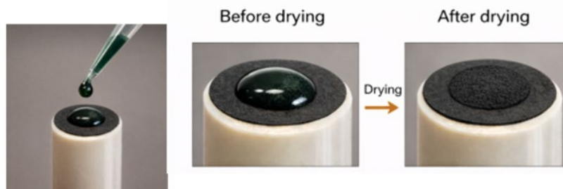
Figura 2. Deposición de tinta de material activo sobre la superficie activa de un electrodo de carbón vitreo.
